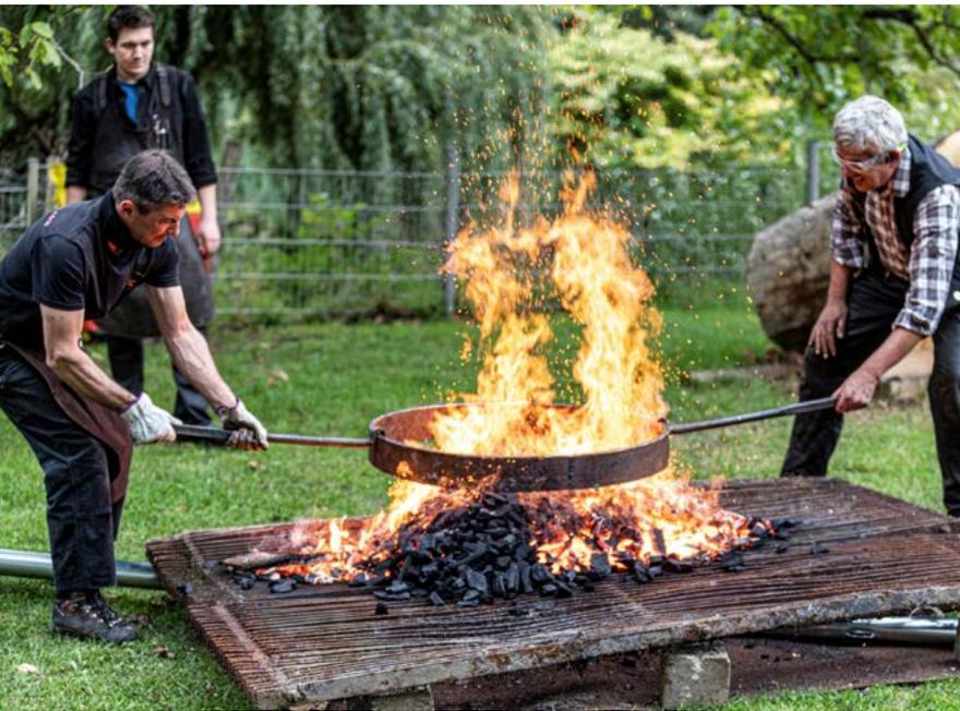
Heiße Schmiedearbeiten sind notwendig, wenn die zentralen Werkzeuge in der Manufaktur, die Schmiedehämmer, instand gesetzt werden.
